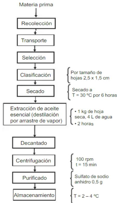
Figura 2. Diagrama de bloques de la extracción de aceite esencial de orégano
